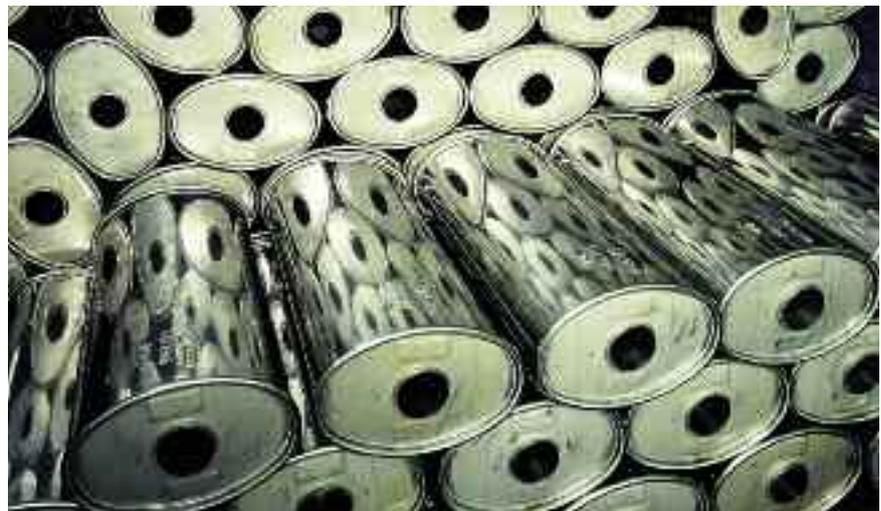
Bild 3: Auspuffanlagen – ein Einsatzgebiet von ferritischem nichtrostendem Stahl im Automobilbau
