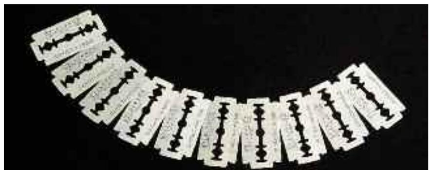
Bild 4: Rasierklingen aus martensitischem nichtrostendem Stahl
